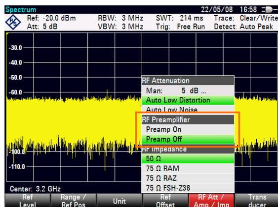
放大的幅度取决于参考电平。与参考电平的这种耦合可确保动态范围处于最佳。
