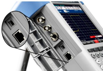
可通过 USB 或 LAN 端口将 R&S FSH 连接到 PC，并进行双向数据传输。
