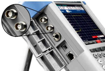
可以对针对各种应用对两个 BNC 连接器进行配置。保护盖的内侧印有连接器的名称。
