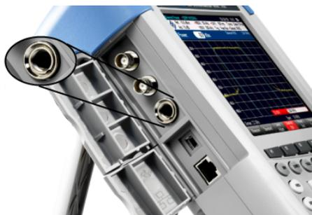
可以将各种附件连接到该 AUX 连接器，如 GPS 接收器 R&S HA-Z240（订货号 1309.6700.02）。
