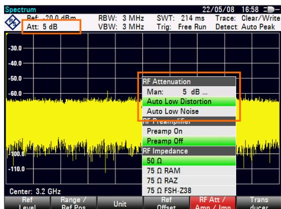
也可以手动设置衰减。R&S FSH 将在 0 至 40 dB 范围内提供衰减，步长为 5 dB。
