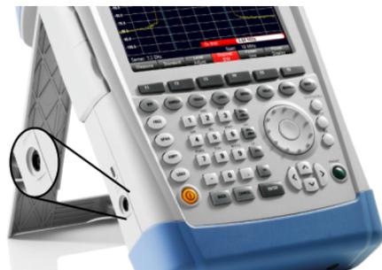
R&S FSH 由交流/直流变压器电源通过直流连接器来供电。也可以使用该直流连接器为电池充电。
